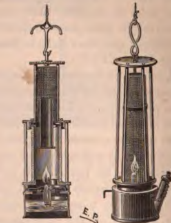
Fig. 59. — Lampe de mineur avec et sans verre.
